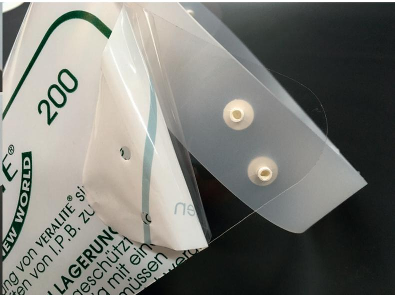
5) Vissez les vis mâles, il n'est pas nécessaire d'utiliser un tournevis
